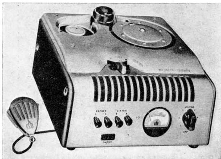
Fig. 12.43. - Adattatore per consentire la registrazione magnetica su filo con apparecchio radio. Costruzione Webster.
